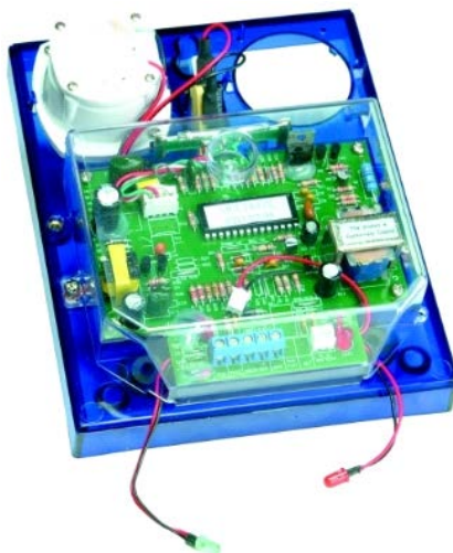
Figura 79. Sirena exterior Multibox. El circuit protegit per una carcassa hermètica. Junt a l'altaveu es troba el microinterruptor de sabotatge.
