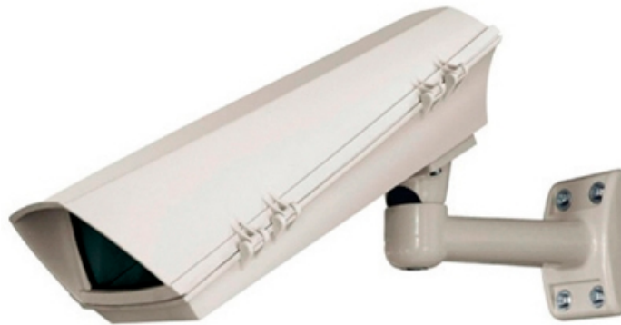
Figura 29. Carcassa exterior amb suport. Obertura lateral, grau de protecció IP-67 i calefactor incorporat.
