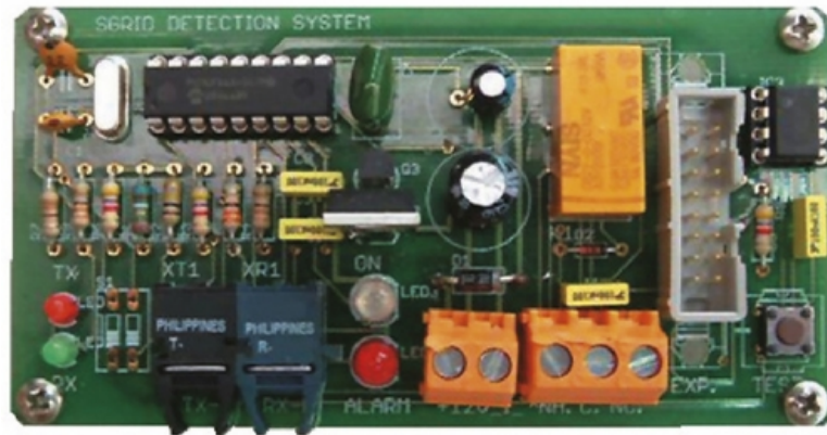
Figura 19. Circuit analitzador d'un llaç de fibra òptica SFA1Z-V. S'observen els terminals de transmissió i recepció, a la part inferior esquerra, i els terminals d'alimentació i alarma, a la part inferior dreta.
