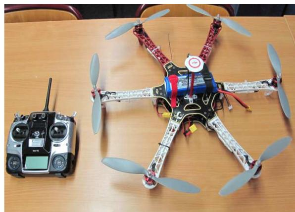
*Figura 1. Drone empleado para la elevación de la cámara y la toma de datos del exterior y el entorno de la cueva.*
