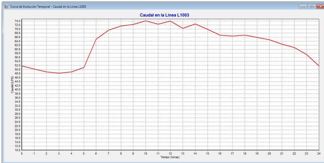
Figura 61. Caudal a la salida de la PTAP de Jimbitono. Modelo modificado.
