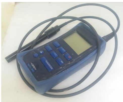
Figura 3.6: Conductímetro utilizado. Modelo WTW Multi 340i. Foto propia.
