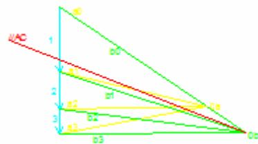
Continuaremos trazando un funicular cuyo último lado pase por B y corte al eje en G.
