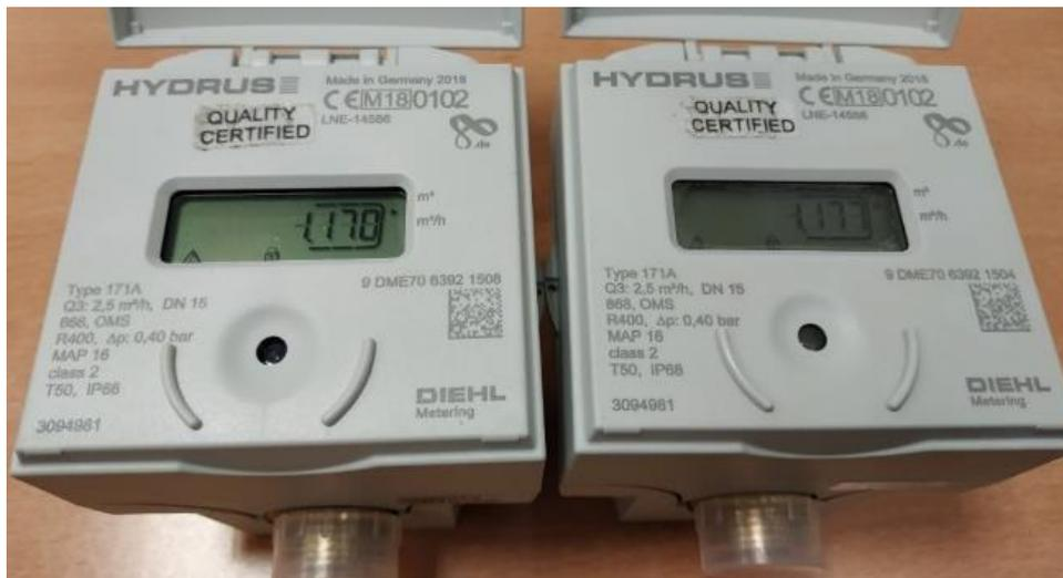
*Imagen 19. Pantalla principal o display de contadores de ultrasonido modelo 4*
