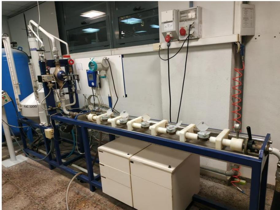
*Imagen 40. Banco de ensayos de contadores en funcionamiento de la Universidad Politécnica de Valencia*
