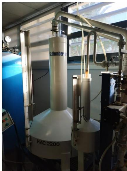
*Imagen 49. Depósitos de volumen conocido del laboratorio de hidráulica de la UPV. Depósito de 200 litros (izquierda) y depósito de 10 litros (derecha).*
