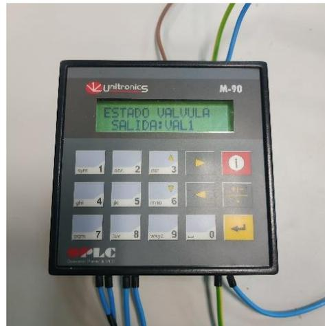
*Imagen 65. Controlador lógico programable, marca Unitronics modelo M-90*
