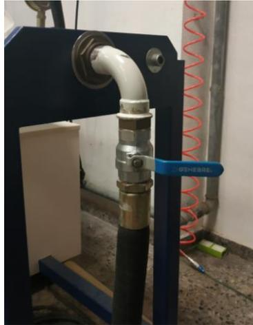
*Imagen 48. Válvula de seccionamiento en la entrada del banco de ensayo.*
