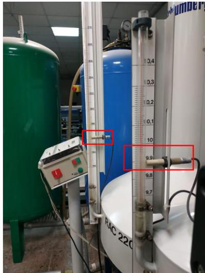
*Imagen 51. Probetas de medida y sensores de corte (rectángulo rojo) en los depósitos de volumen determinado*
