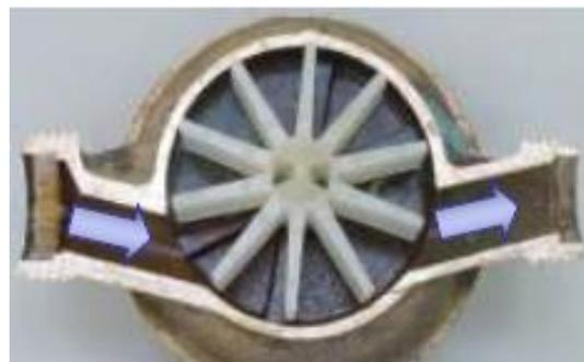
**Imagen 3.** Principio de funcionamiento de un contador de chorro único. En *Gestión Integral de Contadores de Agua* (p. 6), Por Arregui et al., 2007, Valencia, España, Derechos de Autor [2007] por el Instituto Tecnológico del Agua.
