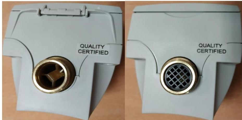
*Imagen 21. Salida (izquierda) y entrada (derecha) de los contadores modelo 4*
