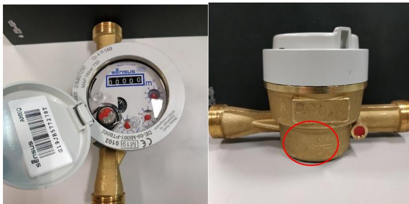
*Imagen 32. Totalizador del contador modelo 10 (izquierda) y vista lateral del contador 10 (derecha)*
