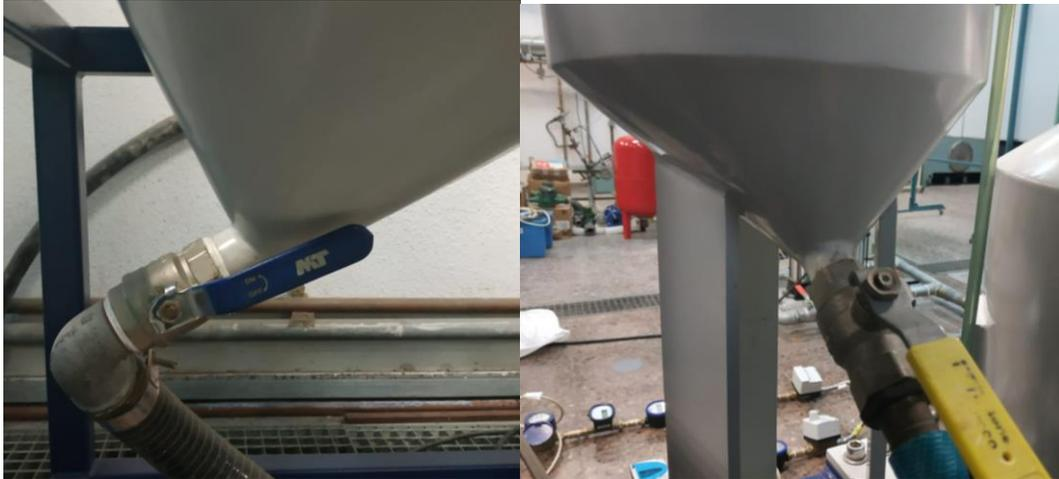
*Imagen 57. Válvulas de desagüe de los depósitos de volumen determinado. Depósito de 200 litros (izquierda) y depósito de 10 litros (derecha).*
