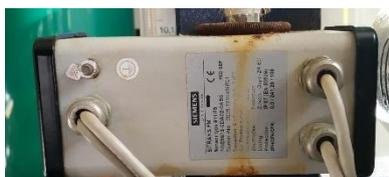
*Imagen 56. Sensor electromagnético Siemens.*
