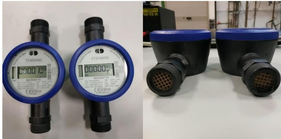
*Imagen 34. Pantalla principal o display de los contadores modelo 11 (izquierda) y entrada de los contadores (derecha).*
