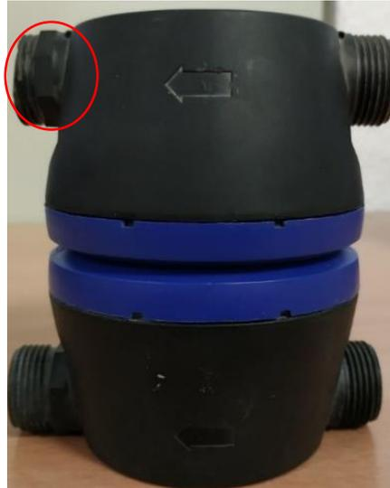
*Imagen 13. Contador 1 (Vista lateral) y avería en la salida del contador*
