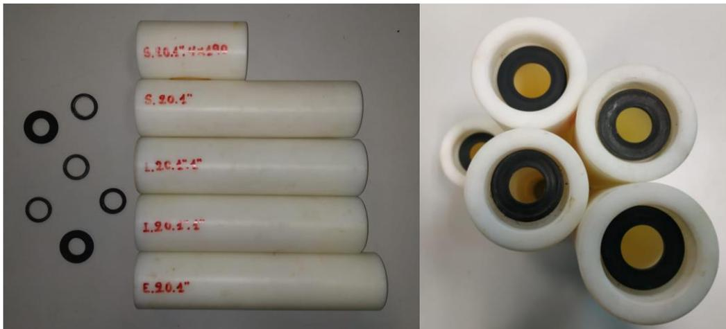
*Imagen 50. Tubos y juntas de unión del banco de ensayos de la UPV*
