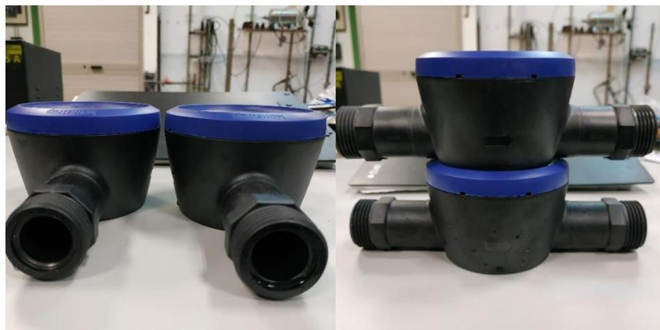
*Imagen 35. Salida (izquierda) y vista lateral (derecha) de contadores modelo 9*
