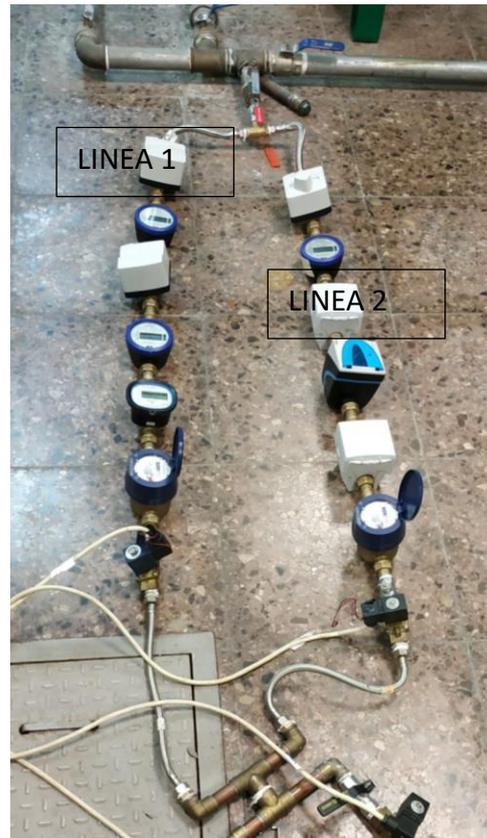
*Imagen 61. Líneas de ensayos del banco para el análisis metrológico en régimen transitorio en el laboratorio de hidráulica de la UPV.*
