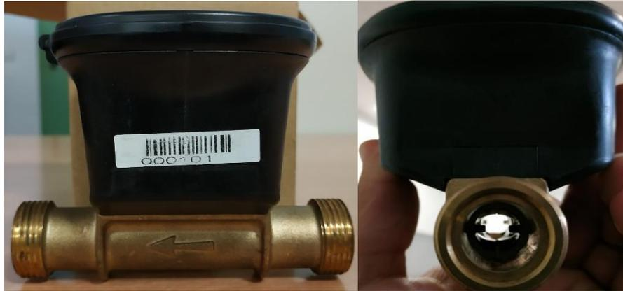
*Imagen 23. Contador 5, vista lateral (izquierda) y entrada del medidor (derecha)*
