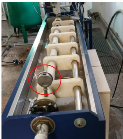
*Imagen 52. Manómetros en línea de ensayos del banco.*
