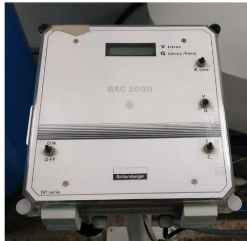
*Imagen 47. Panel de control de ensayos y display para ver el caudal que pasa por la línea 3*
