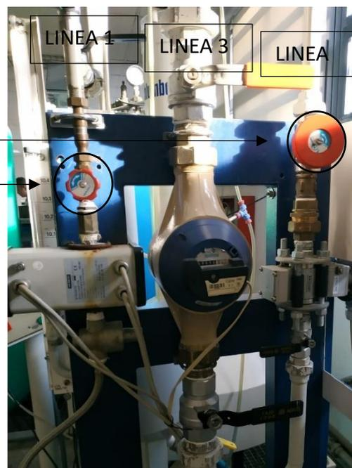
**Imagen 43.** Líneas de regulación del banco de ensayos de la UPV
