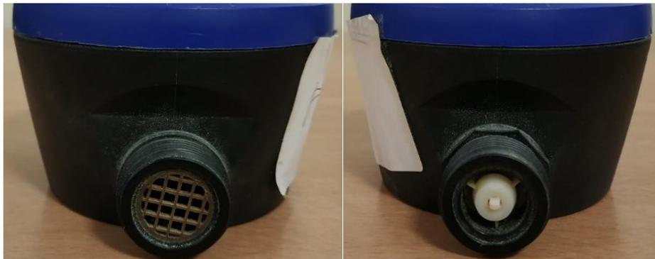
*Imagen 14. Entrada (izquierda) y salida (derecha) del contador modelo 1.*
