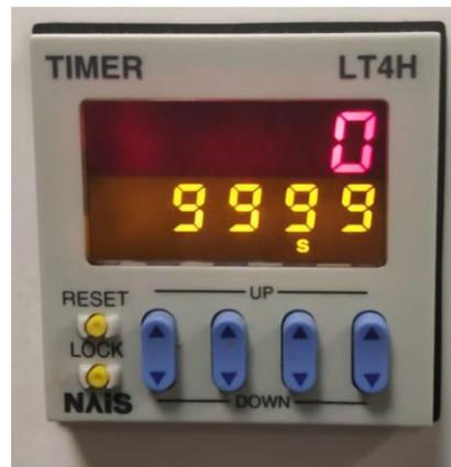
*Imagen 53. Temporizador digital Panasonic, del banco de ensayos de la UPV.*
