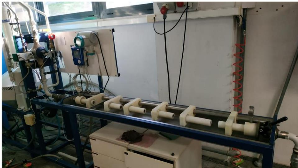
*Imagen 38. Banco de ensayo de contadores de la Universidad Politécnica de Valencia*
