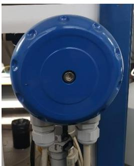
*Imagen 55. Sensor electromagnético marca Krohne.*
