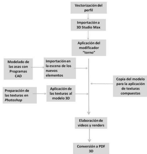
Figura 6: Esquema de la metodología empleada en la elaboración de modelos 3D a partir de dibujos de publicaciones
