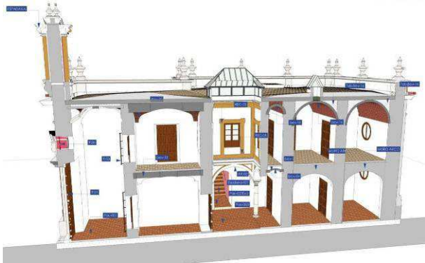
Fig. 4. Sección del modelo de información con ID Identificativos.
