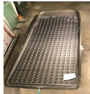
**Imagen 129.** Laminación del tejado (iz. y med.) Curación de éste (der.).
