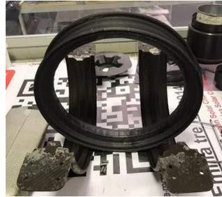
**Imagen 127.** Laminación de un círculo (iz.). Curación de éste (der.).
