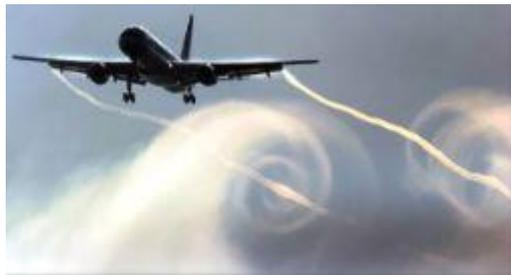
Imagen 62 . Vórtices generados por un avión.
