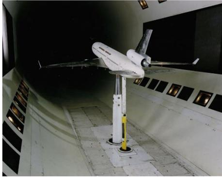
**Imagen 12.** *Avión en un túnel de viento.*
