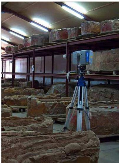
Fig. 7. Escáner Faro LS Photon
