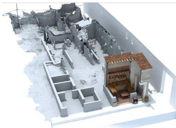
Figura 1- La casa de la Diana Arcaizante en Pompeya, en una imagen compuesta por la malla resultante del escaneado 3D a la que se superponen los muros dibujados en 1910 antes de su bombardeo (en color gris) y una reconstrucción fotorrealista de una de las tabernas que tenía en su fachada.
