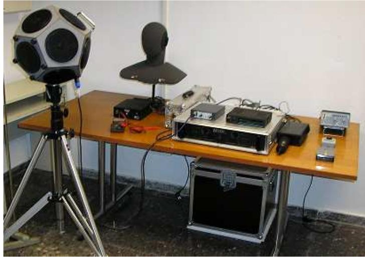
**Figura A.3:** Conjunto del material de medida utilizado. Compuesto por: fuente omnidireccional, cabeza, multímetro y amplificador.
