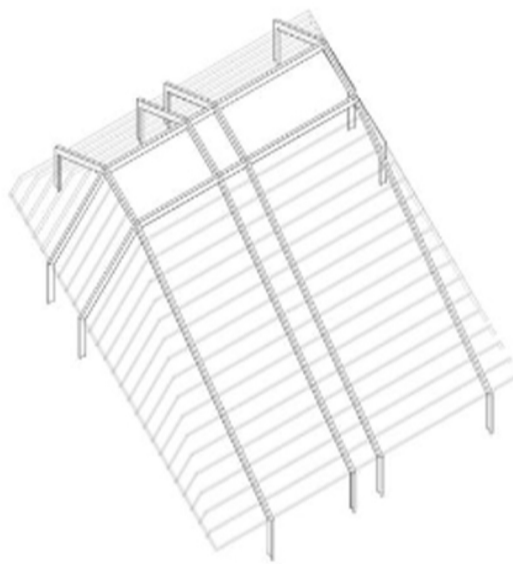
PORTICOS ESTRUCTURALES Perfiles IPE 400x200 + Placa de Anclaje 500x500 e. 1"
