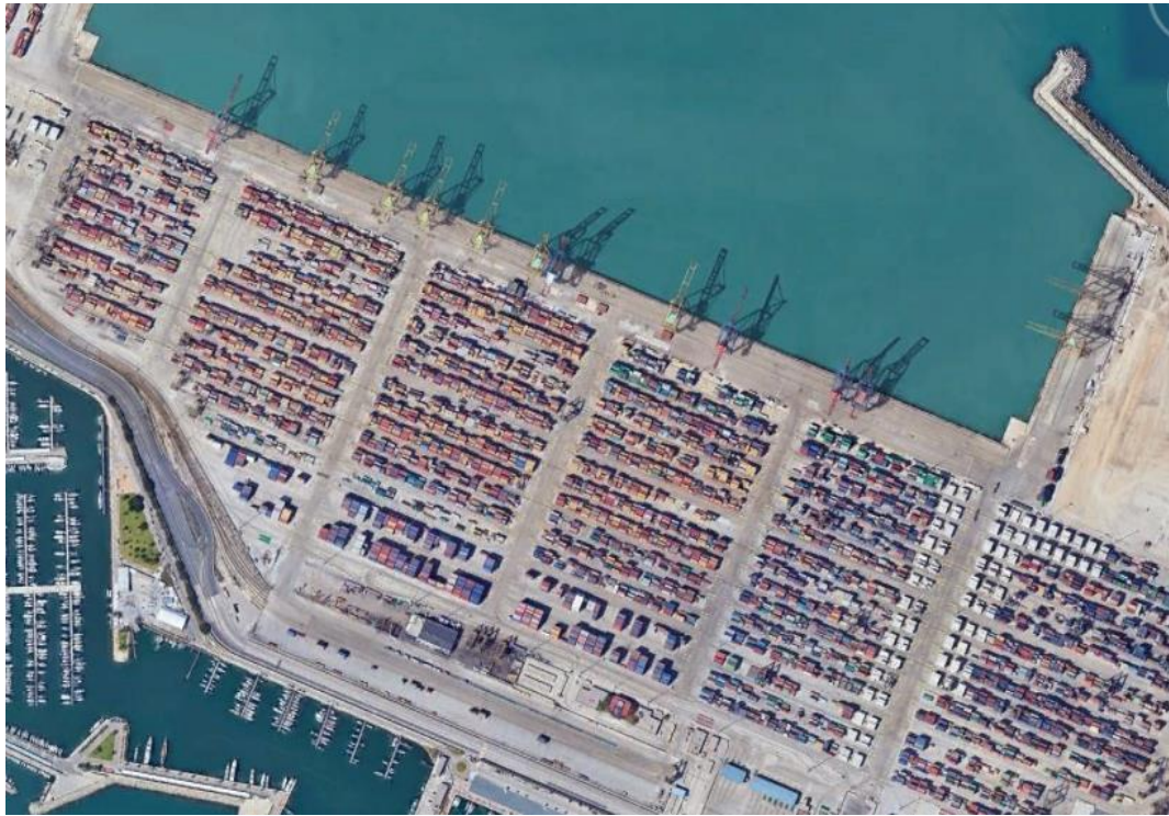
Ilustración 8: Ejemplo Distribución Grúas pórtico de almacenamiento paralelas a línea de atraque y con pasillos perpendiculares.
