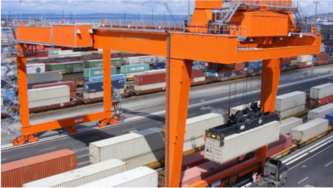
Ilustración 9: Grúa pórtico RMG
