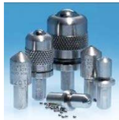
Fig. I.11. Tipos de puntas normalizadas para ensayos Brinell. (San Buenaventura University, 2002, pág. 13)
