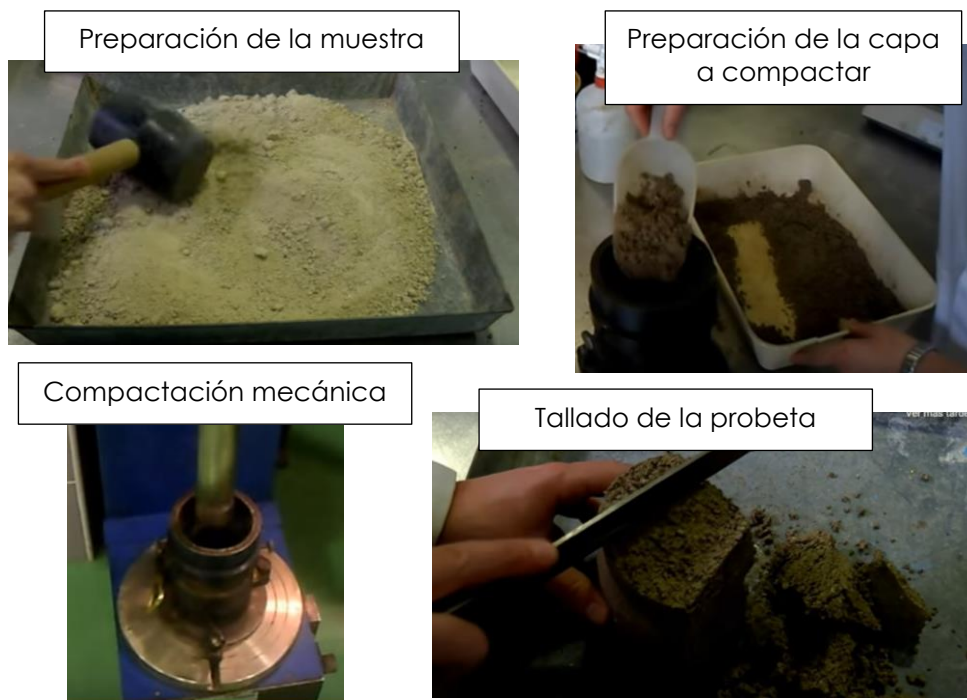
Imagen 4. Fases de procedimiento operatorio del ensayo Proctor.
