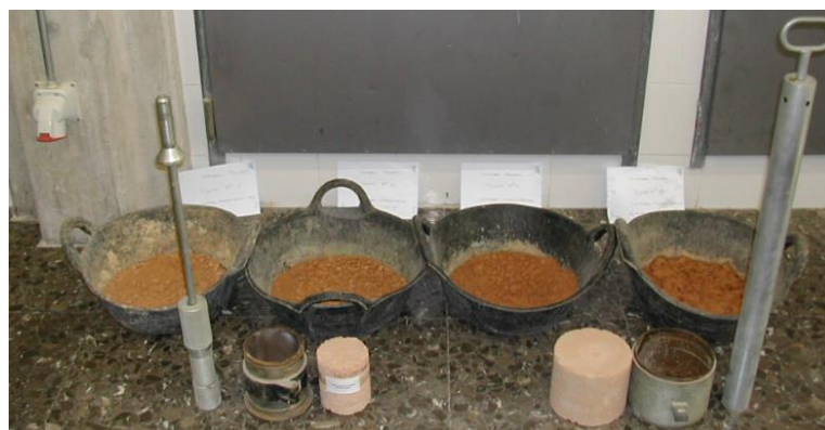
Imagen 3. Muestras de suelo con diferente contenido de humedad.
