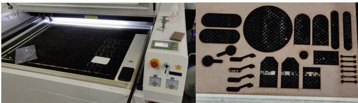
Fig. 10 Primero, cortadora laser; segundo plancha con piezas recortadas. Fuente: propia.
