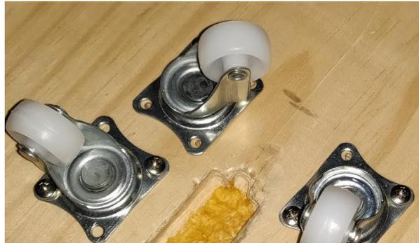
Fig. 7. Ruedas locas en la base del robot. Fuente: propia.
