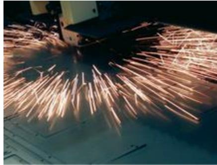
Fig. 9. Corte por laser de planchas de aluminio. Fuente: [19]
