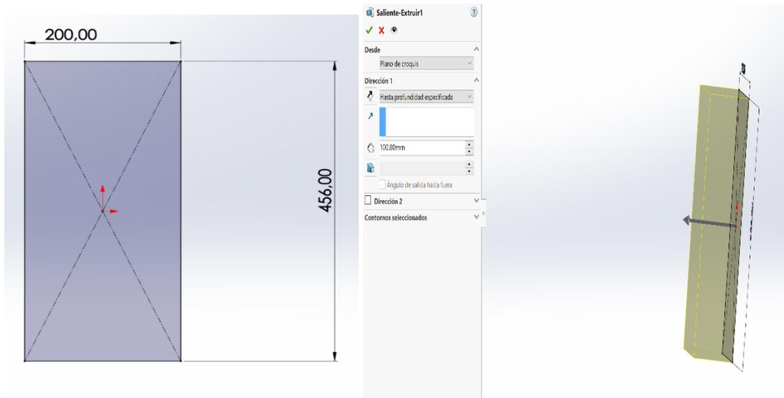
Figura 9. Rectángulo inicial del diseño de la empuñadura y extrusión de ésta
