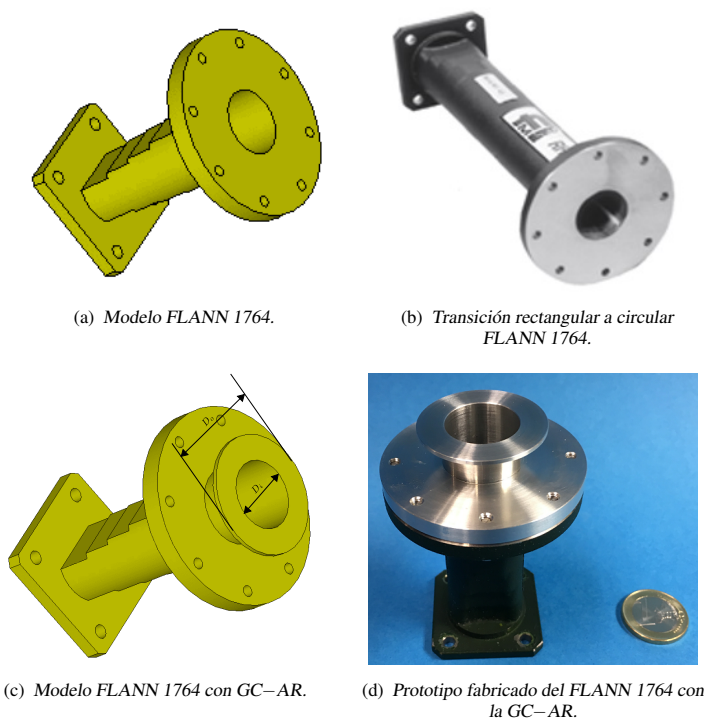
Figura 3.36: Modelos de transición de guía rectangular a circular, para trabajar en la banda de 10 GHz a 14 GHz.
