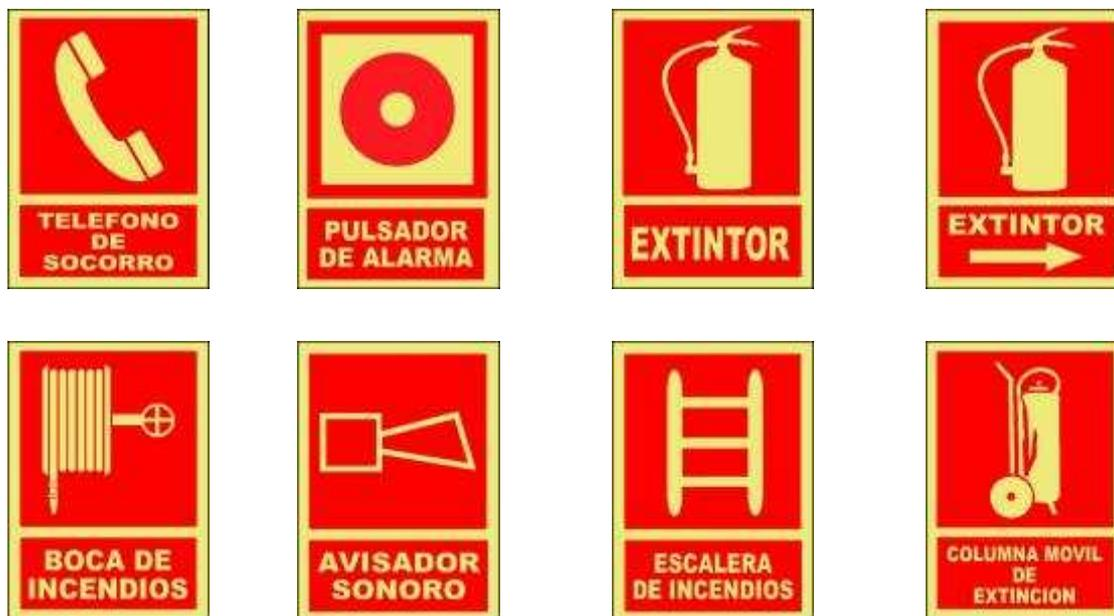
FIGURA 14: Señalización equipos de lucha contra incendios
