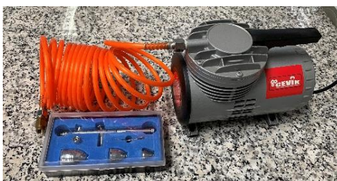
Figura 3. 6: Equipo utilizado en el proceso de aspersión del catalizador de paladio
