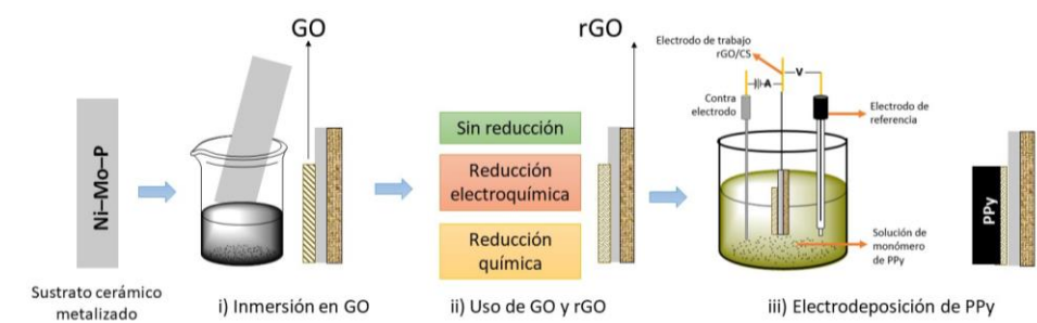
Figura 4. 26: Esquema del proceso de fabricación de los electrodos híbridos del supercapacitor utilizando un sustrato cerámico metalizado (CS)
