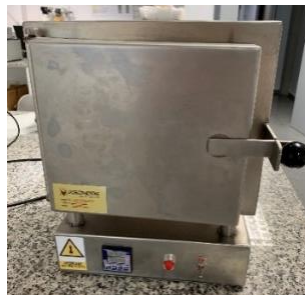
Figura 3. 2: Horno utilizado para el proceso de sinterización de los sustratos cerámicos
