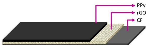
Figura 4. 14: Esquema del electrodo híbrido fabricado sobre el sustrato de fibra de carbono (CF) utilizando óxido de grafeno reducido (rGO) y polipirrol (PPy)
