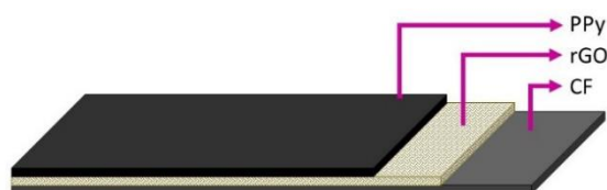
Figura 3. 10: Esquema del electrodo híbrido fabricado con polipirrol (PPy) y óxido de grafeno reducido (rGO) sobre el sustrato de fibra de carbono (CF)
