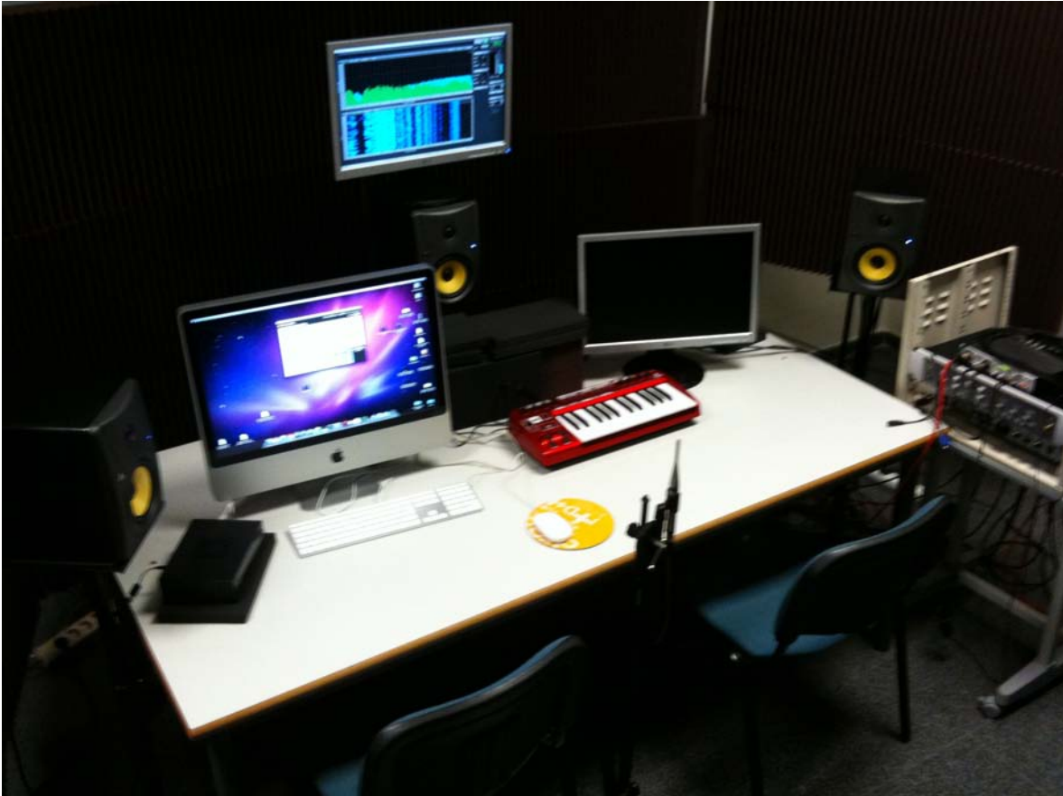
Ilustración 33 - Medición de respuesta en frecuencia de la sala de mezcla. Microfono situado en el punto de escucha. Monitor superior muestra la señal limpia y la de los altavoces.
