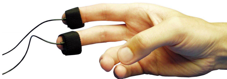
FIGURA 13 – MÁQUINA DE RESPUESTA GALVÁNICA DE LA PIEL
