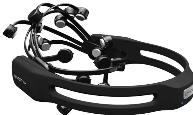
FIGURA 11 – MÁQUINA DE ELECTROENCEFALOGRAFÍA EMOTIV, MODELO EPOC+
