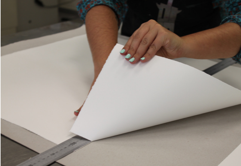
3.1 Comprobando la dirección de la fibra y rasgando el papel a la medida
