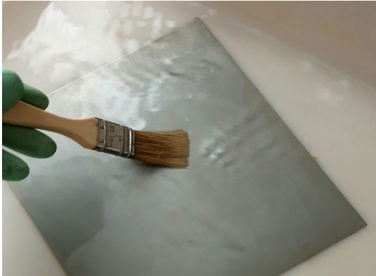
d. Retirada de posibles residuos metálicos con pincel mientras se lava con abundante agua
