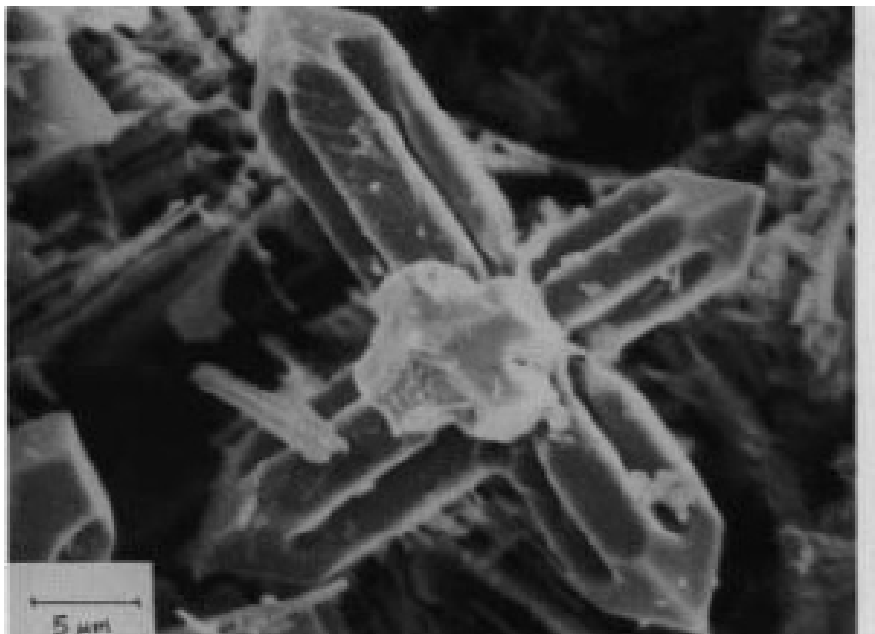
2.5 Ampliación dendrita en composición Fe-34Cr5Nb-4.5C.
