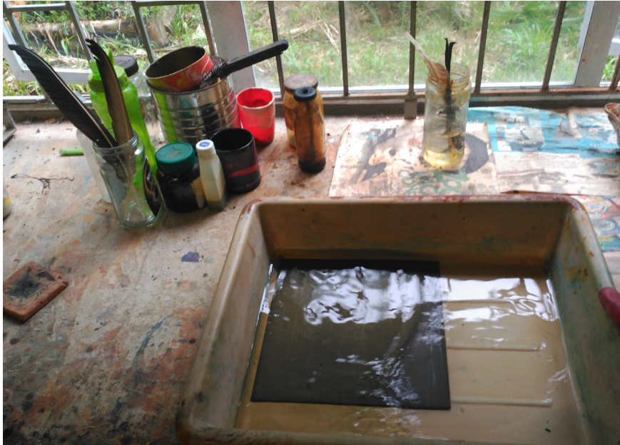
2. 11 Pasivación con ácido nítrico al 10 %. Taller procesos alternativos en litografía. Universidad Tecnológica de Pereira, Colombia, 2017
