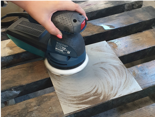
b. Graneado de la plancha con grano del 80, 120 y 220
