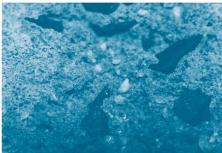
Foto 1: Aspecto de uma amostra após ensaio com o equipamento tipo jato cavitante.
