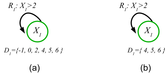
Figura 2.7: Nodo-consistencia: (a) dominio original y (b) dominio nodo-consistente.
