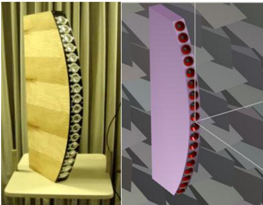
Figura 11 Array CBT construido por Keele en [1] y modelo en 3D en el software EnclosureShop®
