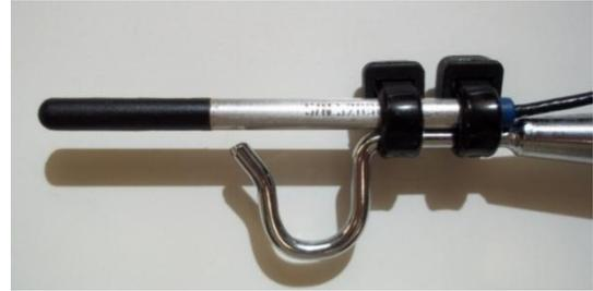
Fig. 12. Foto del hidrófono *Reson TC4038*
