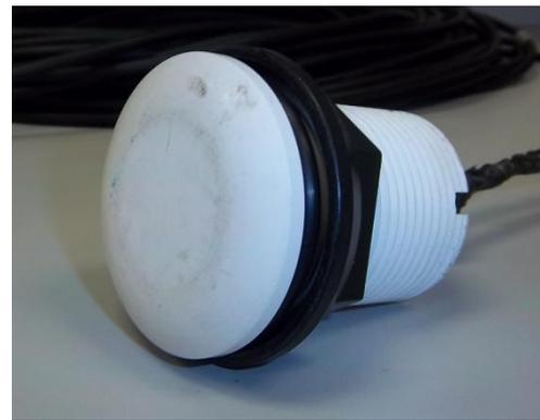
Fig. 13. Foto del transductor *Simrad sn 101 Complete*
