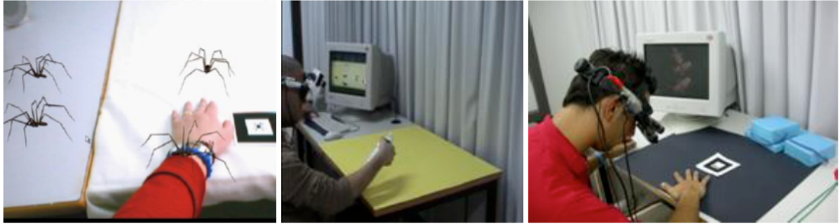
Figura 26. Tratamiento de fobias: a) Primer sistema de RA para tratar fobias a insectos; b) Sistema de RA con marcadores invisibles; c) Sistema de RA mediante HMD optical see-through
