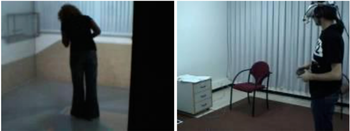
Figura 27. Sistemas para el tratamiento de la acrofobia. a) Usuario inmerso en un sistema CAVE; b) Sistema de RA.
