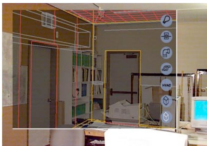
Figura 38. Vista de la estructura de un edificio mediante RA
