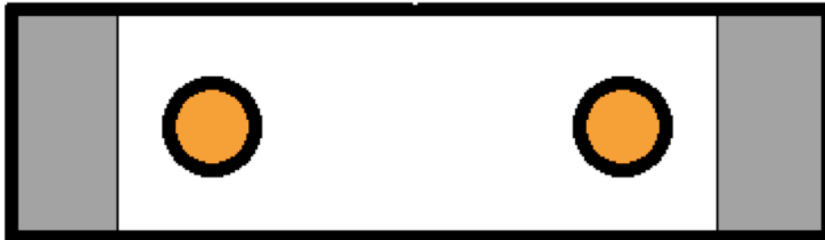
Figura 11 - Los círculos naranjas representan la imagen mientras que las franjas grisáceas representan la zona del sensor eliminada de la imagen
