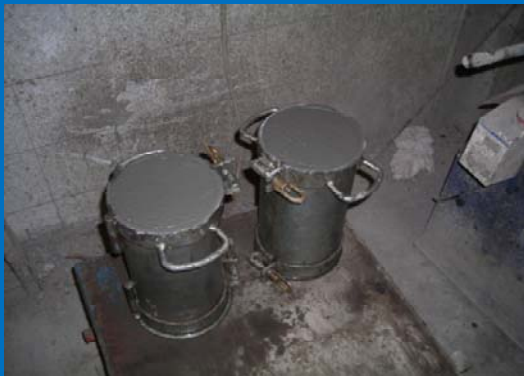
Probetas de control preparadas
