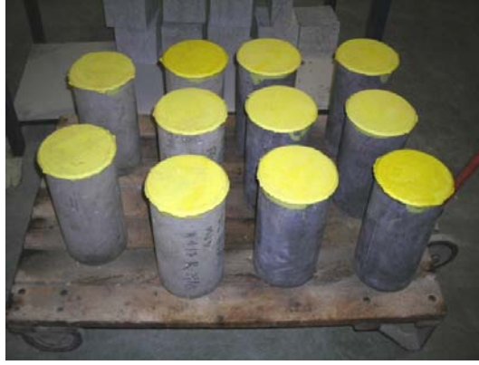
Figura C.2. Probetas de control utilizada en los ensayos (HC y HAR).
