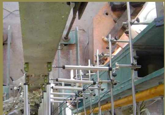
Captadores de desplazamiento posicionados
