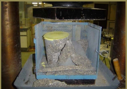
Rotura de las probetas de control
