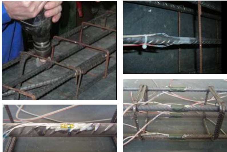
Figura 4.12. Procedimiento para el correcto pegado de las bandas extensométricas.
