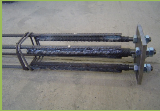
Barras soldadas en el extremo de la armadura
