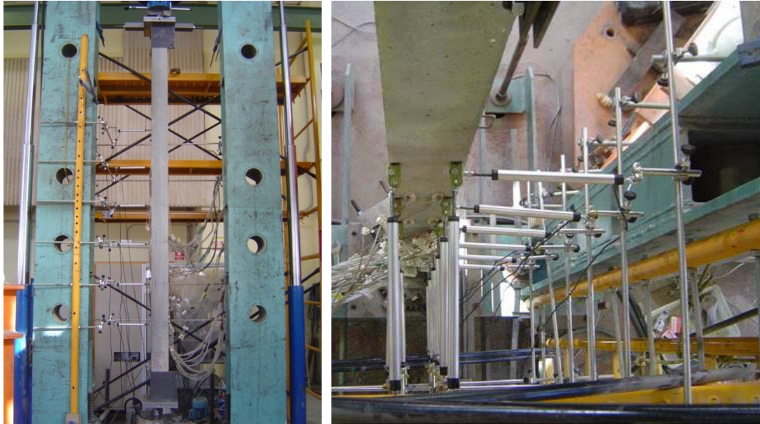
Figura 4.26. Soporte posicionado en el pórtico de ensayo con toda la instrumentación conectada.
