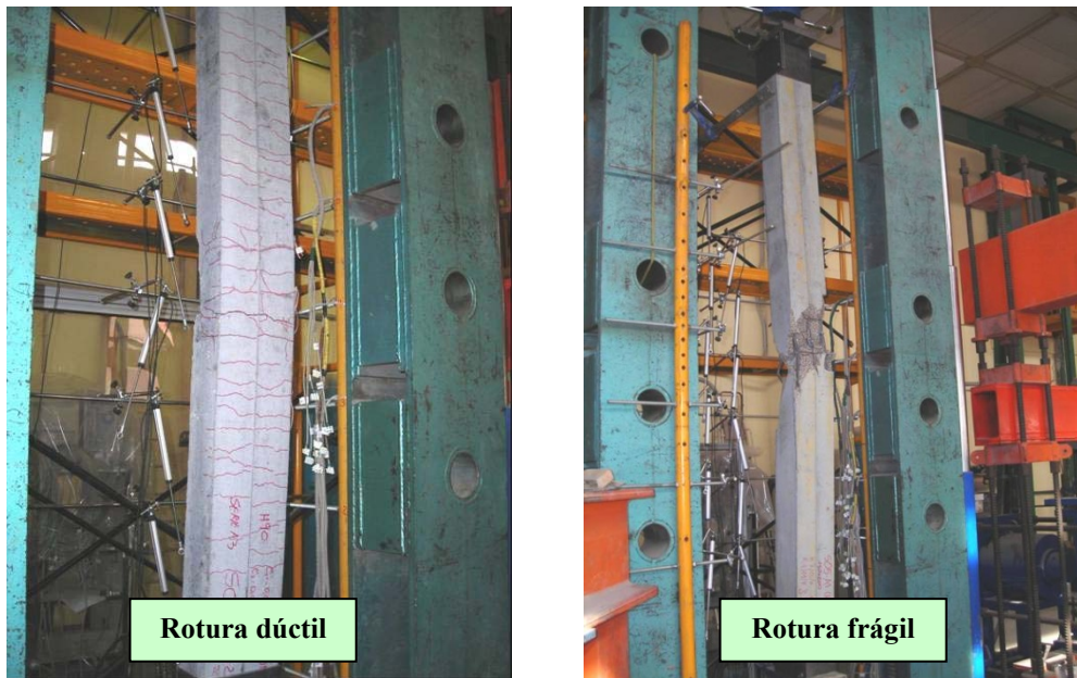
Figura 4.29. Rotura del soporte.
