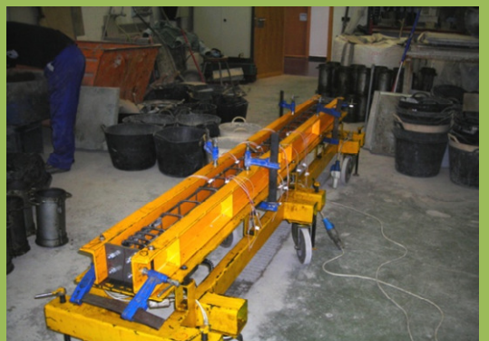
Armadura en el encofrado
