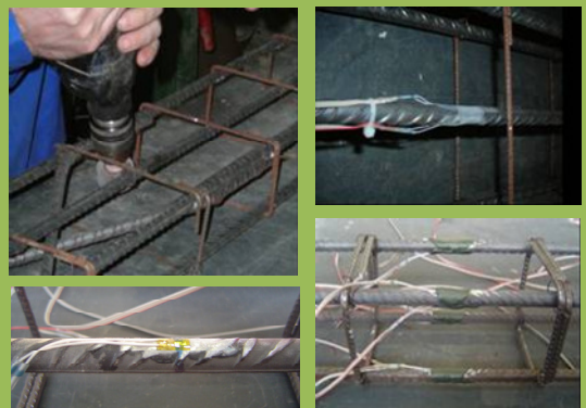
Disposición de bandas extensométricas
