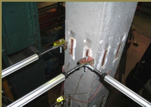
Galgas de hormigón y captadores posicionados
