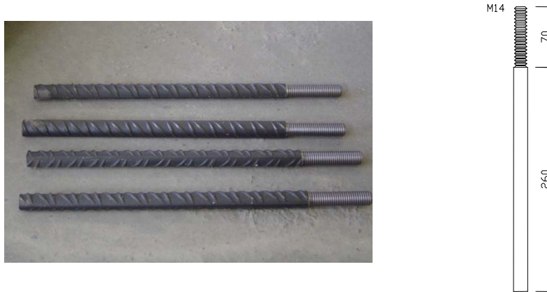
Figura 4.3. Barras roscadas de diámetro 16 mm, con rosca de métrica 14 y 70 mm de longitud.
