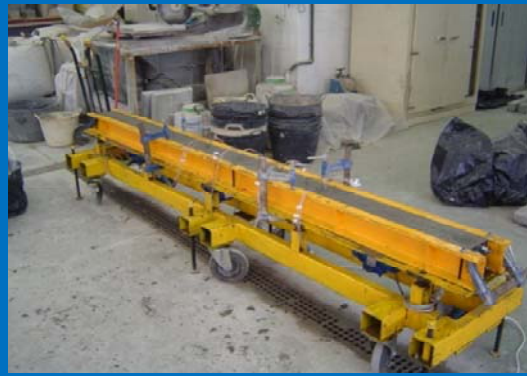
Hormigón fresco en el encofrado
