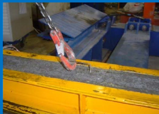
Agarradera metálica para izado del soporte
