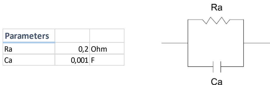
Figura 61: Primer circuito eléctrico equivalente.
