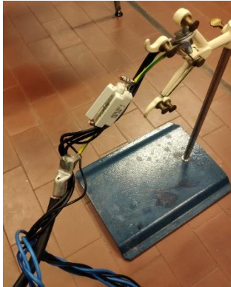
Figura 31: Segundo circuito modelo compuesto de una resistencia de 2\ \text{Ohm} y una fuente de 12\ \text{V} .
