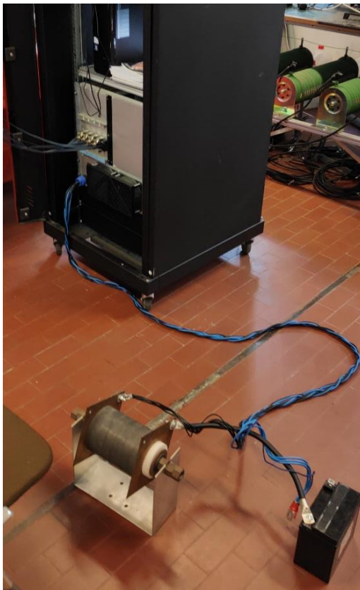
Figura 30: Primer circuito modelo compuesto de una resistencia 25 \Omega y una fuente de 12 V.
