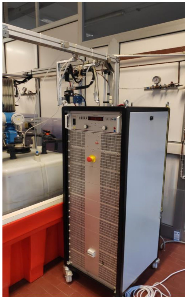
Figura 24: Sistema de control y regulación de potencia.
