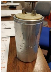
Figura 33: Tercer circuito propuesto, acoplado en paralelo a la resistencia un condensador.
