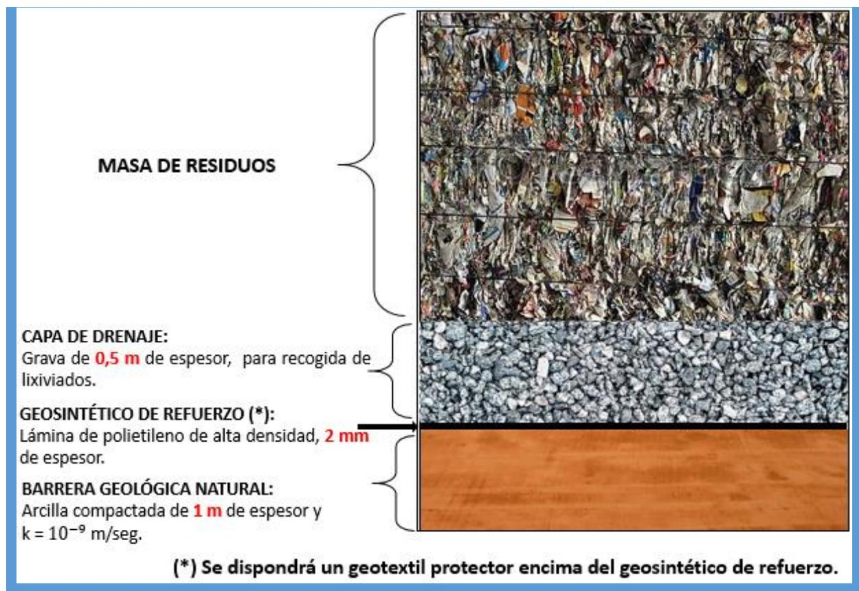
**Figura 42: Esquema de impermeabilización en el fondo del vaso para residuos no peligrosos**
