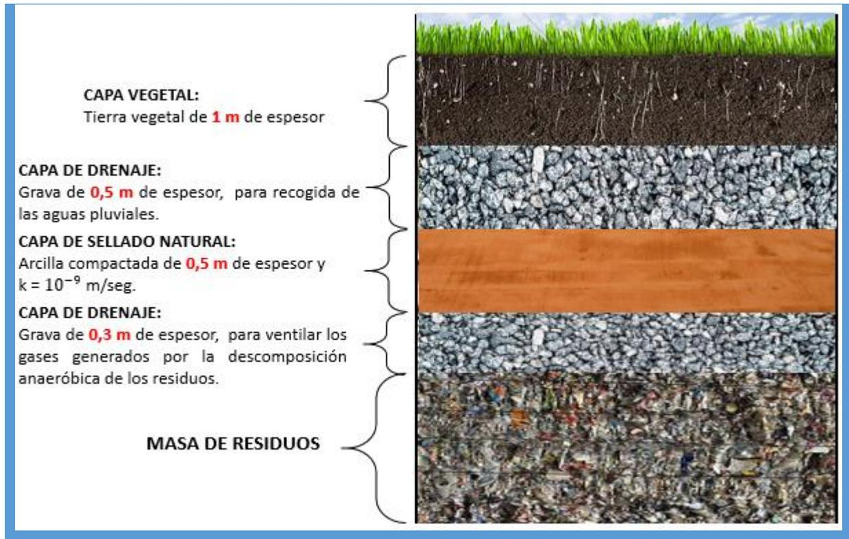
**Figura 43: Esquema de la capa de sellado superior para residuos no peligrosos**
