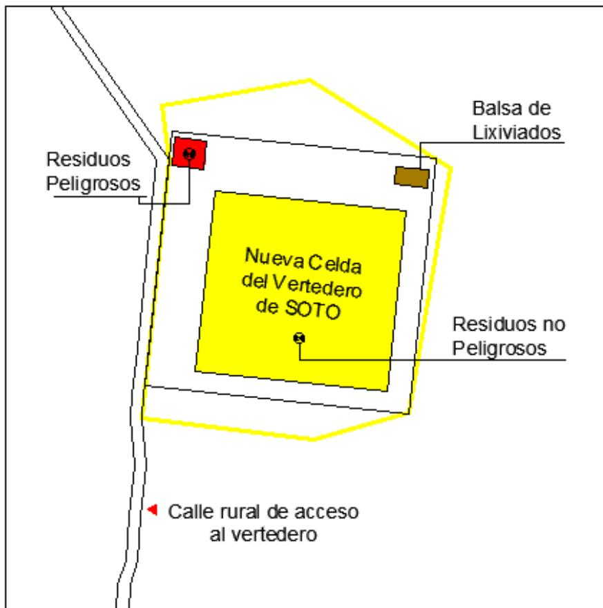
**Figura 44: Diseño de la nueva celda del vertedero de Soto.**
