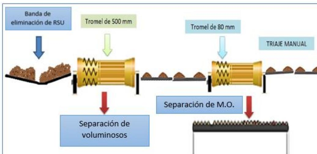
**Figura 17: Esquema de tamizado con trómel.**
