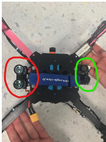
FIG. B.2: **Cercle rouge**: capteur de distance LIDAR-Lite V3; **Cercle vert**: PX4FLOW smart caméra.
