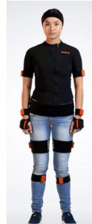
FIG. 2.1: Capteurs XSENS AWINDA. SOURCE:[30]      FIG. 2.2: Position des capteurs. SOURCE:[30]
