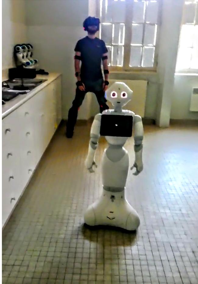
FIG. 1.2: Téléopération de Pepper par la technique du *Danseur d'Ombres*
