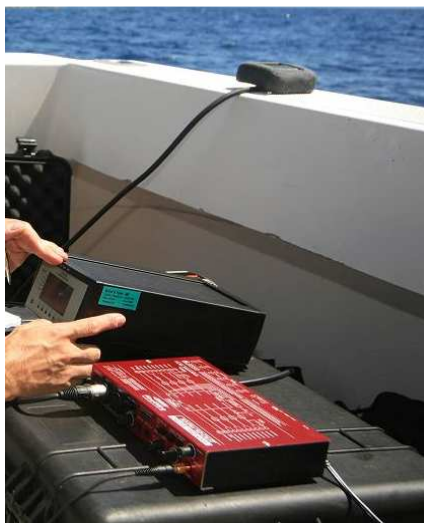
Fig. 11. Medición de ruido en el área de estudio. Amplificador acondicionador Briel&Kjaer NEXUS y tarjeta de adquisición externa Edirol FA-101.
