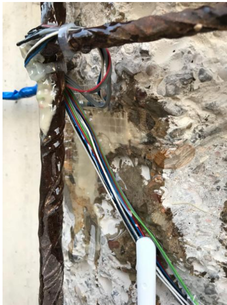
Ilustración V-40 Galgas protegidas con X60
