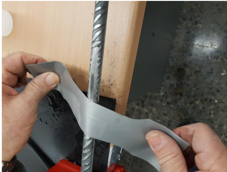
Ilustración V-34 Lijado de la Barra
