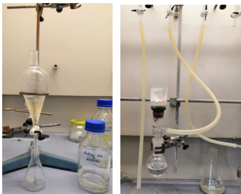
Figura 4.3. Embudo de decantación conteniendo una fase orgánica densa y una inorgánica menos densa en el momento anterior a la separación de fases mediante la apertura de la válvula en la parte inferior del embudo (imagen de la izquierda). Producto de síntesis disuelto en fase orgánica tras ser filtrado a vacío para separar el sulfato de magnesio anhidro empleado en la eliminación del agua del producto (imagen de la derecha).
