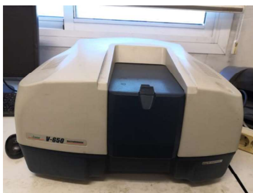
Figura 3.2. Espectrofotómetro ultravioleta-visible utilizado durante la realización de este proyecto.
