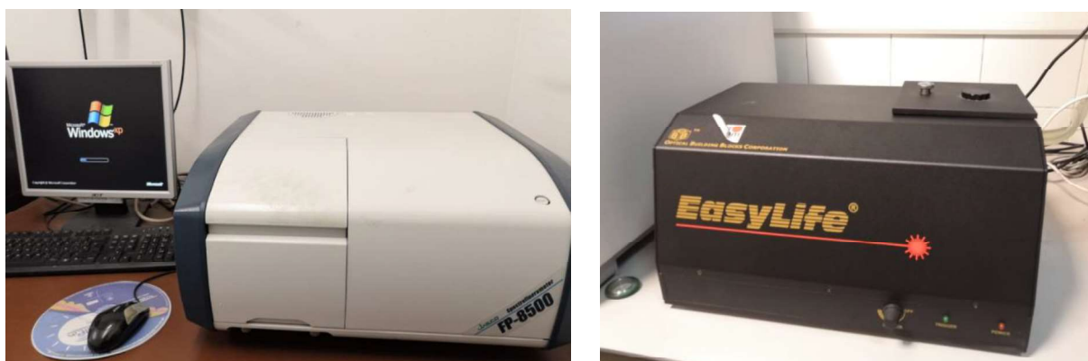
Figura 3.3. Espectrofotómetro de estado estacionario (imagen de la izquierda) y de resolución temporal (imagen de la derecha) utilizado durante la realización de este proyecto.
