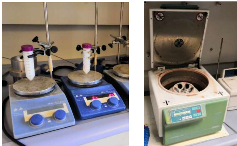
Figura 4.22. Tubos Falcon conteniendo dos sólidos en su interior mientras son agitados en un agitador magnético con placa calefactora antes de ser introducidos en la centrifuga (Imagen de la izquierda). Centrifuga utilizada durante la síntesis de los sólidos (Imagen de la derecha).
