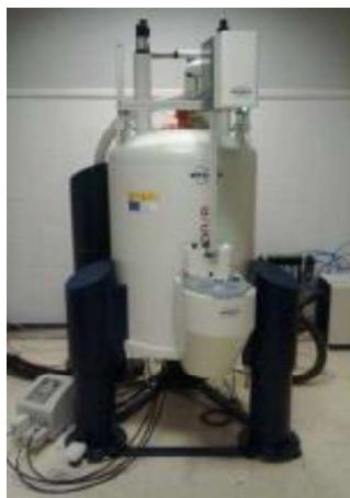
Figura 3.7. Espectrómetro de resonancia magnética Bruker Avance III.
