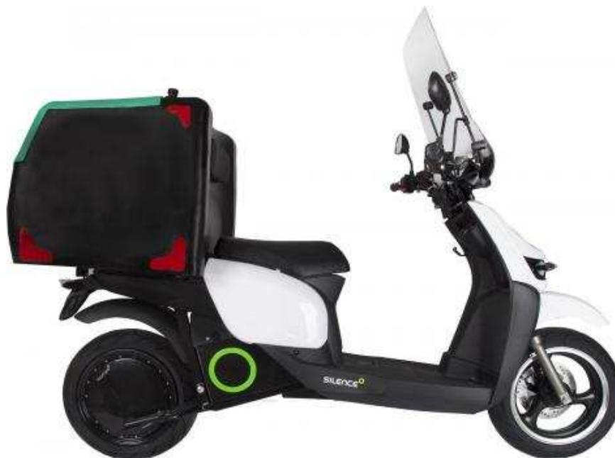
FIGURA 28: scooter eléctrico Silence S02 con baúl de 200 L, orientado a mensajería. Fuente: (Ortega, 2019).
