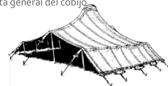
se observan los patrones que forman la membrana y los anclajes de estacas clavadas en el terreno
