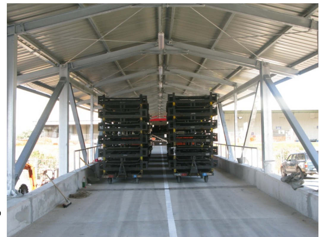
Carga en el centro del vano
