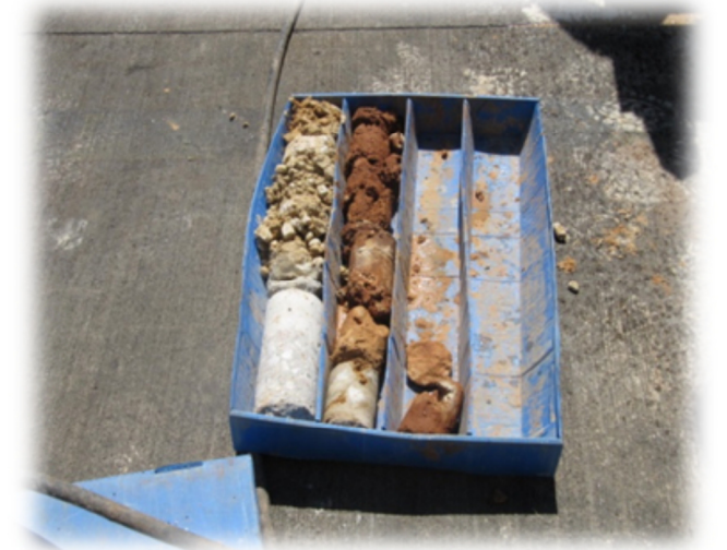
Fotografías de la extracción de testigos en la zona explanada
