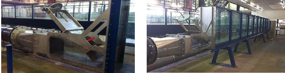
Figura 2. Canal Emulsiona 2. Detalle del dispositivo de alimentación, boquilla y compuerta de entrada (izda.) y vista general del canal Emulsiona 2 (dcha.).
