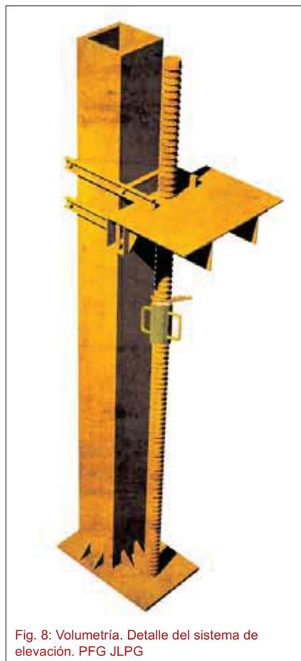
Fig. 8: Volumetría. Detalle del sistema de elevación. PFG JLPG
