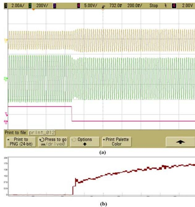
**Figura 5-20. (a) Comportamiento del sistema en situación de *islanding* sin desconexión del inversor, con carga RLC. Superior: corriente de salida del inversor, 2 A/div. Central: Tensión sobre la carga local, 200 V/div. Inferior: Señal de desconexión de red, 5 V/div. Escala de Tiempo: 200 ms/div. (b) Comportamiento de la salida del filtro Goertzel,  $Ay_k$ , escalada ( $\times 3$ ), la cual es una variable interna del DSP.**
