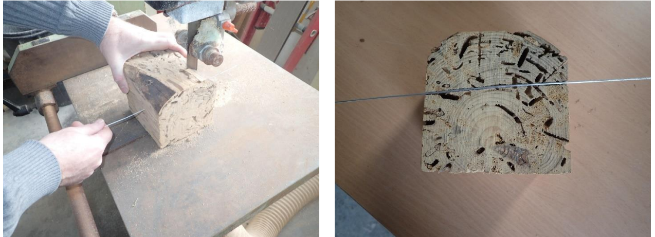
Figura 25. Corte muestra 3_N2 incisión nº5 y recorrido de la broca. Fuente: Elaboración propia.
