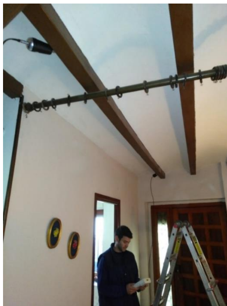
Figura 30. Ensayo de ultrasonidos en forjado de madera mediante método indirecto. Fuente: Elaboración propia.
