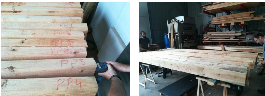
Figura 20. Realización ensayo vibraciones inducidas. Fuente: Elaboración propia.
