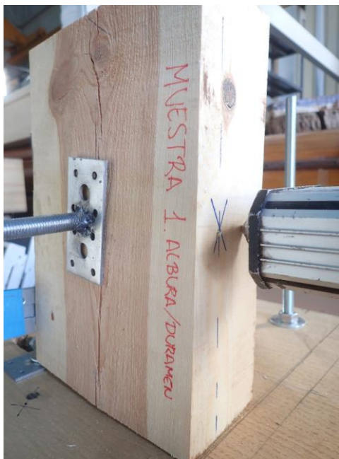
Figura 4. Punto de incisión nº2 y recorrido de la broca. Fuente: Elaboración propia.
