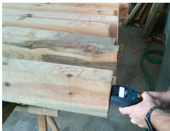
Figura 11. Realización ensayo vibraciones inducidas. Fuente: Elaboración propia.
