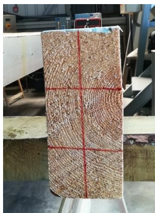
Figura 13. Marcaje incisión taladro para colocación de sensores de ultrasonidos. Fuente: Elaboración propia.
