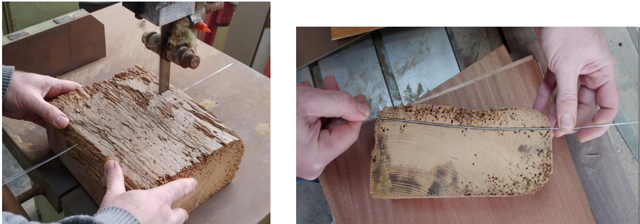
Figura 11. Corte muestra 3_N2 incisión n°5 y recorrido de la broca. Fuente: Elaboración propia.
