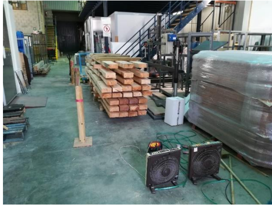
Figura 5. Secado de vigas en almacén. Fuente: Elaboración propia.
