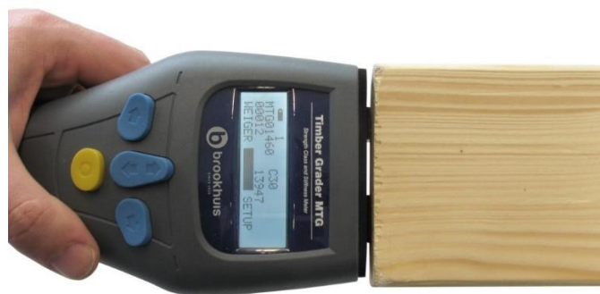
Figura 44. Resultados de un ensayo con el equipo de vibraciones inducidas Timber Grader MTG. El aparato proporciona en su pantalla el módulo de elasticidad (13947 N/mm 2 ) y la clase resistente de la madera (C30), que depende de su módulo de rotura. Fuente: Brookhu.
