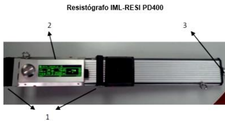
Figura 9. Instrumento de perforación. 1: asideros; 2: unidad digital de registro de datos; 3: aguja perforadora. Fuente: AIDIMME.
