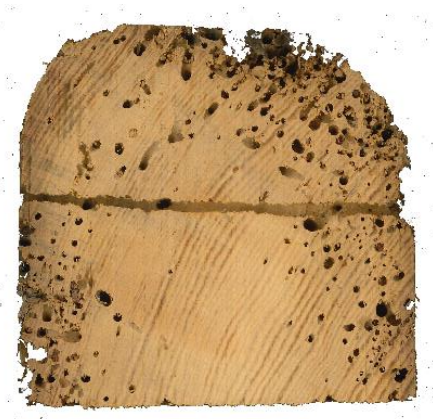
Figura 12. Visualización digital muestra 1, incisión n°4 tipología carcoma fina. Fuente: Elaboración propia.
