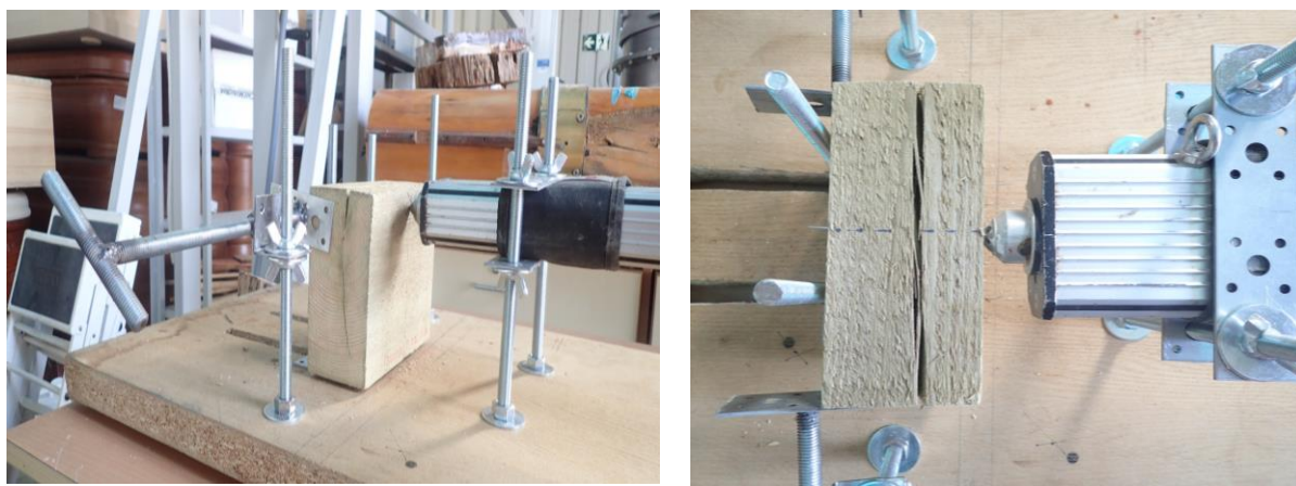
Figura 20. Punto de incisión nº9 y recorrido de la broca. Fuente: Elaboración propia.
