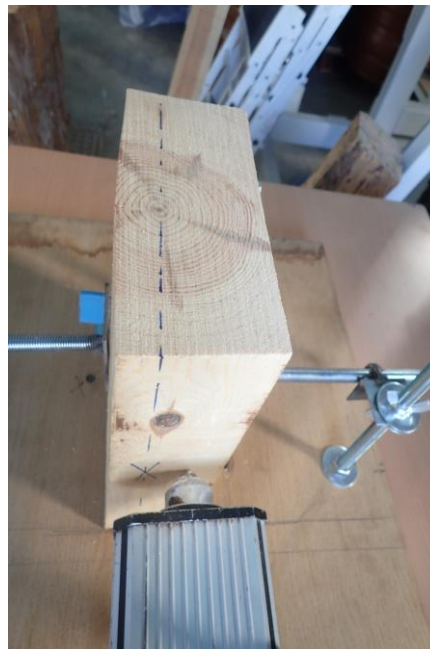
Figura 4. Punto de incisión nº2 y recorrido de la broca. Fuente: Elaboración propia.
