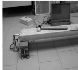
Figura 4. Detalle de la colocación del micrófono y balanza
