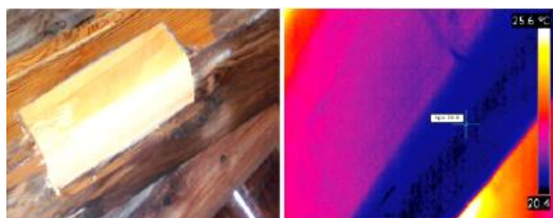
Figura 69. Termograma de la vista de un par con nudos. Fuente: Rodríguez-Liñan et al. (2011).
