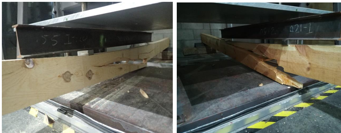
Figura 14. Rotura de vigas en ensayo a flexión. Fuente: Elaboración propia.
