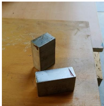
Figura 37. Soportes metálicos ensayo a flexión. Fuente: Elaboración propia.
