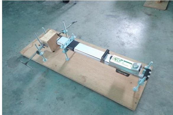
Figura 24. Conjunto equipo banco de ensayo/resistógrafo/probeta. Fuente: Elaboración propia.
