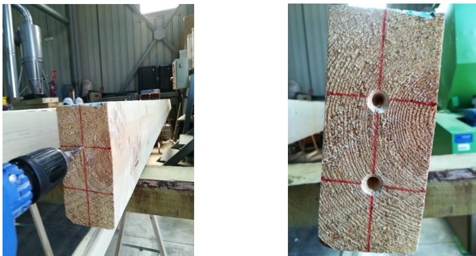
Figura 15. Realización de orificios para la posterior colocación de sensores. Fuente: Elaboración propia.
