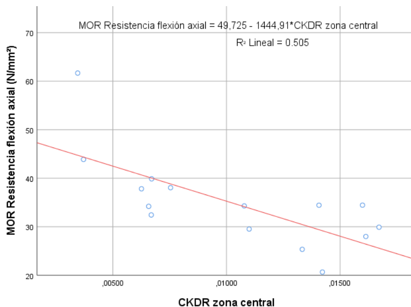
Figura 19. Regresión lineal entre MOR resistencia flexión axial y CKDR zona central, para la especie pino laricio. Fuente: Elaboración propia.
