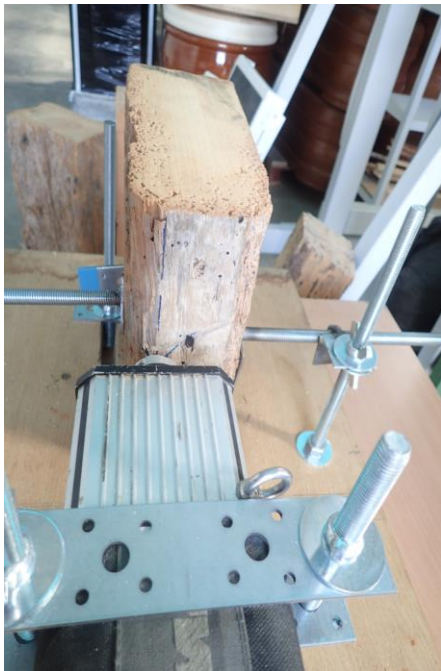
Figura 9. Punto de incisión nº5 y recorrido de la broca. Fuente: Elaboración propia.
