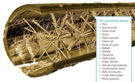
Figura 21. Reconstrucción 3D del interior de un tronco mediante CT Log. A partir de la Figura puede realizarse un aserrado óptimo, con el mínimo desperdicio de material. Fuente: Microtec.
