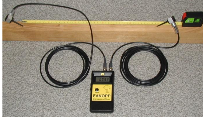
Figura 43. Equipo de vibraciones inducidas con FAKOPP Microsecond Timer. El aparato proporciona solamente la velocidad de la onda de presión (en microsegundos). Fuente: FAKOPP
