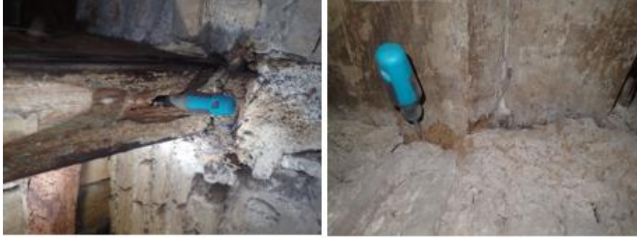
Figura 73. Penetración en la madera del punzón en diferente grado. Fuente: AIDIMME.
