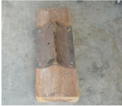
Figura 35. Zancas madera/metal para apoyo de vigas en ensayo rotura a flexión. Fuente: Elaboración propia.
