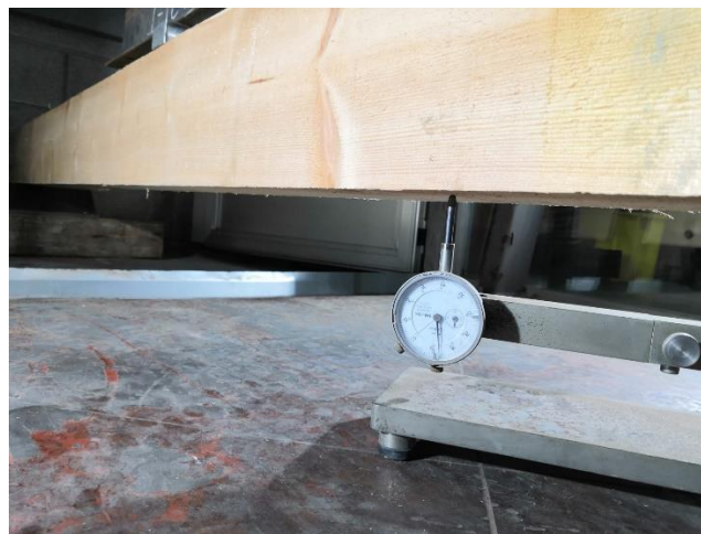
Figura 4. Medición de deformación real mediante galga en viga PS 16. Fuente: Elaboración propia.
