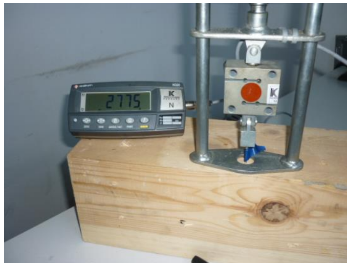
Figura 57. El aparato para esta técnica consta de un dispositivo de sujeción del tornillo, un transductor que registra la fuerza máxima de arranque, y un husillo, para la extracción del tornillo. Fuente: SANITE.
