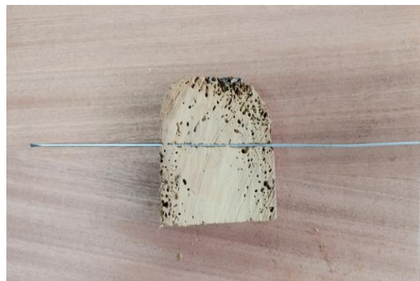
Figura 10. Corte muestra 3_N2 incisión nº4 y recorrido de la broca. Fuente: Elaboración propia.
