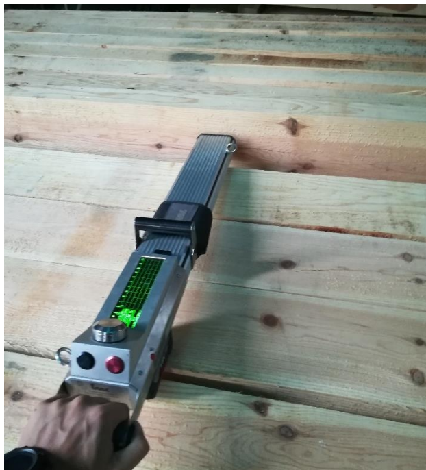
Figura 23. Realización resistografía horizontal. Fuente: Elaboración propia.
