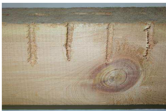
Figura 61. Corte de la probeta con los agujeros de los tornillos alcanzando un nudo oculto y fibra desviada. Fuente: Casado et al. (2005).
