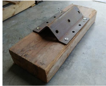
Figura 35. Zancas madera/metal para apoyo de vigas en ensayo rotura a flexión. Fuente: Elaboración propia.
