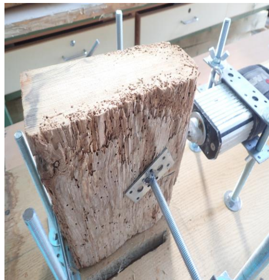
Figura 9. Punto de incisión nº5 y recorrido de la broca. Fuente: Elaboración propia.
