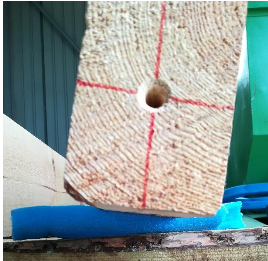
Figura 19. Acomodación de viga para la realización de ensayo de vibraciones inducidas. Fuente: Elaboración propia.
