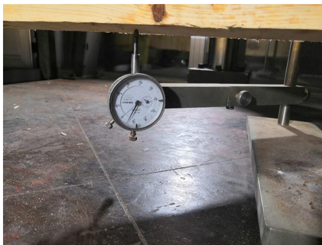
Figura 5. Medición de deformación real mediante galga en viga PN 16. Fuente: Elaboración propia.
