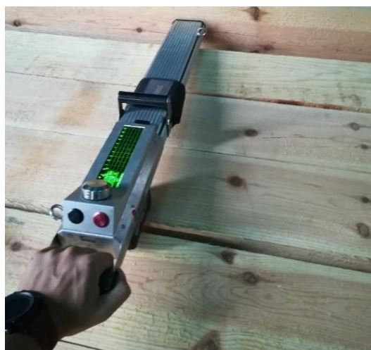
Figura 12. Realización de resistografía horizontal. Fuente: Elaboración propia.
