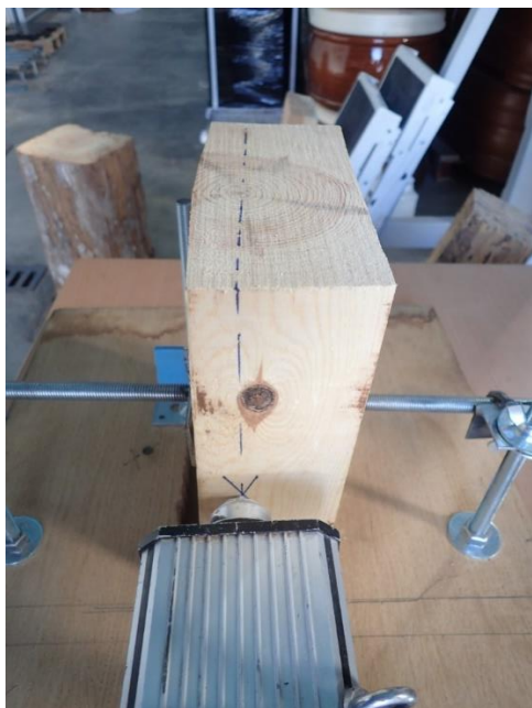
Figura 2. Punto de incisión nº1 y recorrido de la broca. Fuente: Elaboración propia.
