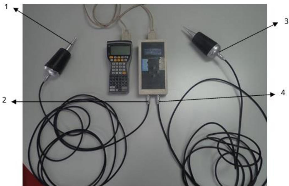
Figura 14. Equipo Sylvatest TRIO. 1; transductor emisor, 2; conector de transmisión ultrasónica, 3; transductor receptor, 4; conector de recepción ultrasónica. 2017. Fuente AIDIMME.
