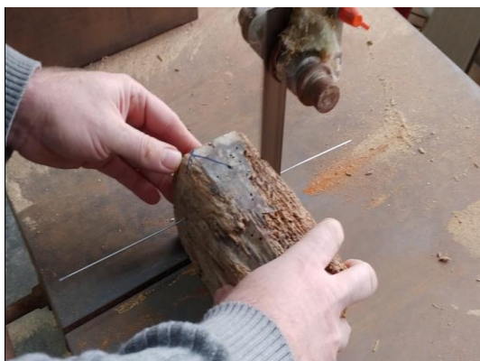
Figura 10. Corte muestra 3_N2 incisión nº4 y recorrido de la broca. Fuente: Elaboración propia.
