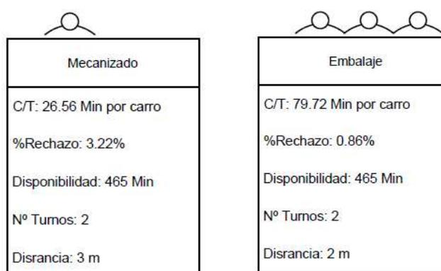
Ilustración 13: VSM – Mecanizado y Embalaje
