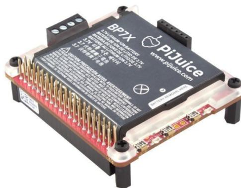
**Figura 59. Alimentador para sistema autónomo.**
