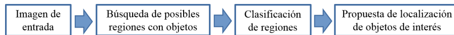
Figura 1: Esquema general de los pasos a seguir habitualmente para la localización automática de objetos en una imagen.
