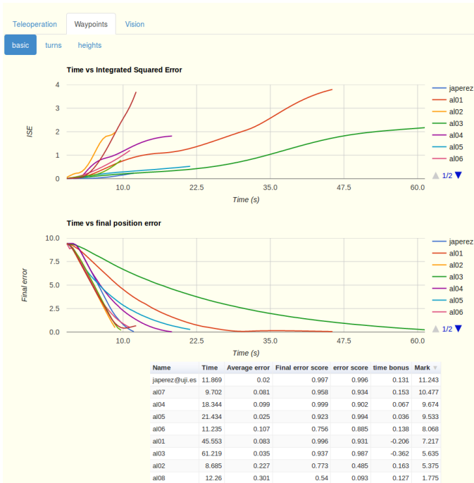
Figura 9: Resultados de seguimiento de tuberías dinámico mediante waypoints para el escenario básico utilizando la simulación en la nube.
