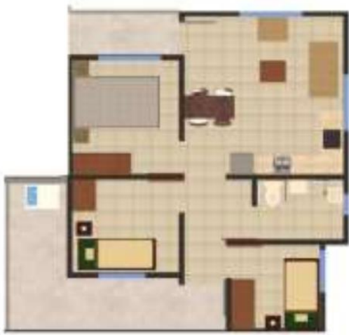
Ilustración 15: Planta Arquitectónica Departamento 54, 67 m 2
