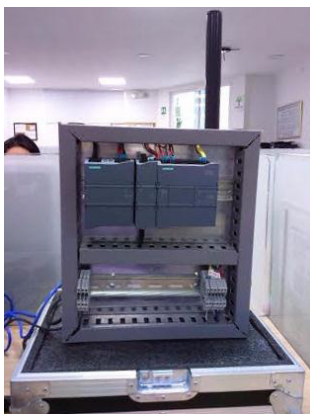
Figura 7. PLC en su soporte con módulo de comunicación y antena (RTU).
