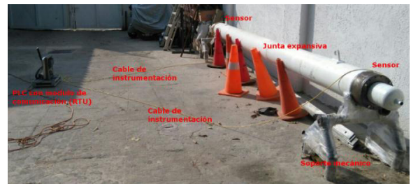
Figura 17. Disposición de todos los equipos para la prueba del sistema de monitoreo electrónico.
